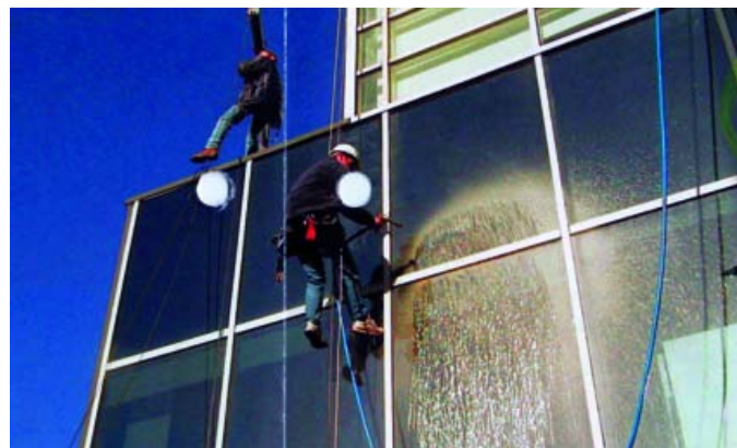
Figuur 5.59 Testen lucht- en waterdichtheid op locatie
