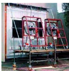
Figuur 5.58 Testen lucht- en waterdichtheid in laboratorium
