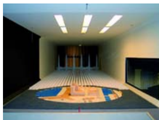
Figuur 5.54 Windtunnelonderzoek van een stedelijke situatie
